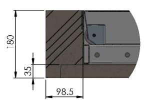
Bis 3cm Betoniert für modularer Schacht Deckel Schwarz
